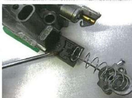
Przepustica nowego w nowym PX-ie ma charakterystyczne przetłoczenia.
