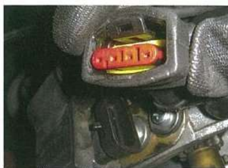
Moduł CDI podłączony przez nowy, wodoodporny konektor
